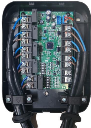
5.3 ábra: A kábelvezetés és rögzítés módja.
