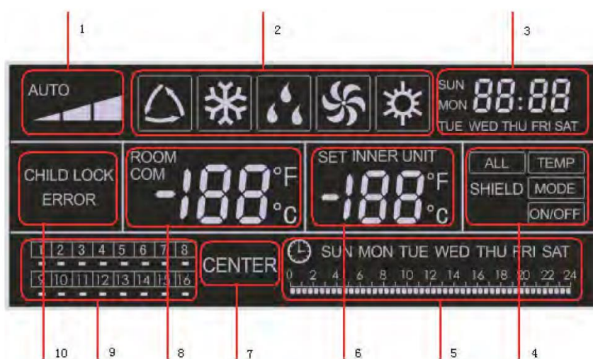
Fig. 2.2: Explication des symboles sur l'écran LCD
